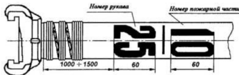
Рис. 3. Дополнительная маркировка рукава в пожарной части
